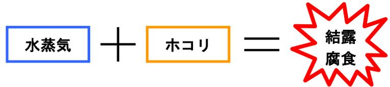
通常、電気箱には水抜き穴が設置されており、結露対策の装置を取り付けても箱内にホコリや水蒸気が入ってしまうという問題があります。しかし、電気箱を閉鎖してしまうと電気箱内で結露した水が溜まってしまいますので、水抜き穴が必要になる、という矛盾が生じます。
